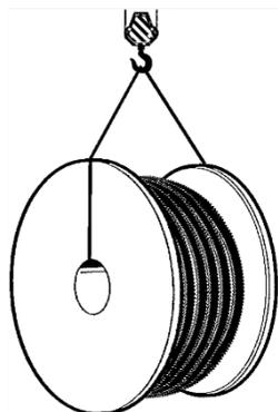
Выгрузка осуществляется аналогичным способом с помощью крана соответствующей грузоподъемностью. Максимальный вес катушки с трубой 1700 кг.
