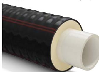
Гибкий трубопровод в однотрубном исполнении в пенополиуретановой изоляции. Давление 10/16 бар, для тепловых сетей с температурным графиком 115/70°С
