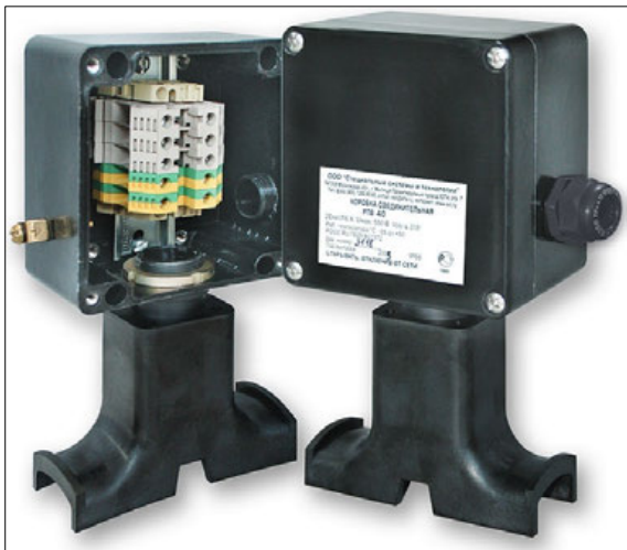
Рис. 26. РТВ 401. Соединительная коробка с устройством ввода кабеля под теплоизоляцию для подключения к силовой сети саморегулирующихся электрических нагревательных кабелей
