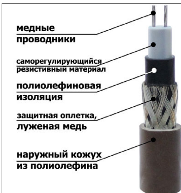
Рис. 25. Конструкция саморегулирующегося термокабеля
