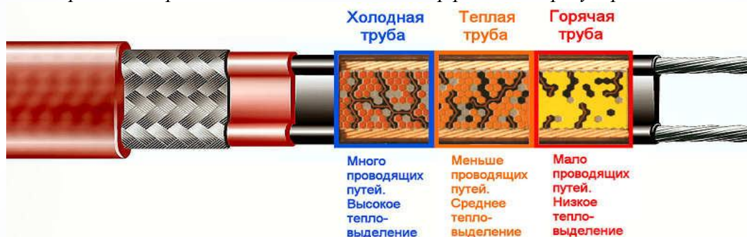
Рис.4. Принцип работы саморегулирующейся тепловыделяющей матрицы.
